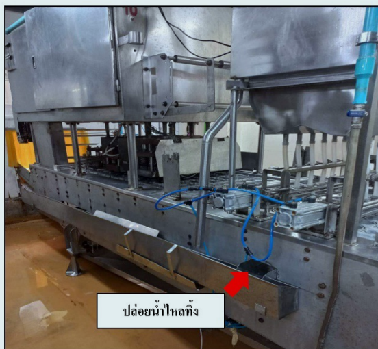
ภาพที่ 1.1 เครื่องบรรจุก่อนติดตั้ง CIP โมบายล์
