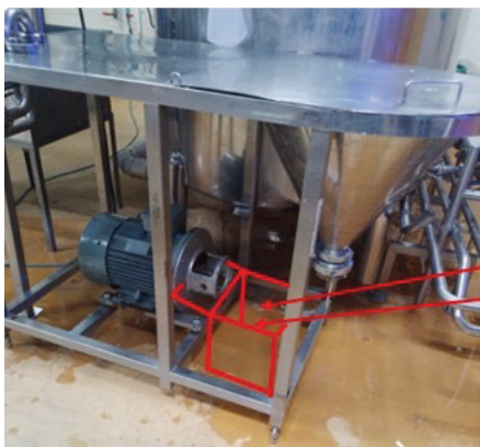
ทำอ่างใส่น้ำที่จะใช้หล่อแมคซิลปั๊มซีลรี่ มาวางกับปั๊มซีลรี่เพื่อจัดตำแหน่ง
